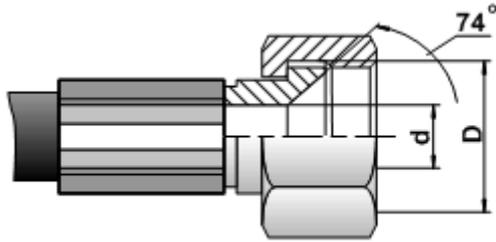
**DKI-(Г)** фитинг с накидной гайкой
